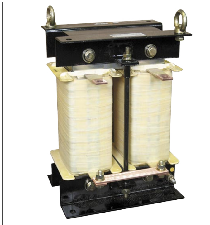
Rys. 5. Dławik typu ED1W – 0,5 mH/70 A dc , f ac = 10 kHz zaprojektowany z rdzeniem z klasycznej stali transformatorowej
