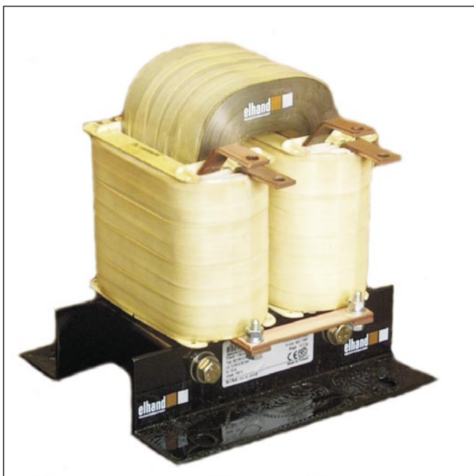
Rys. 4. Dławik typu AD1W – 0,5 mH/70 A dc , f ac = 10 kHz z rdzeniem z materiału amorficznego, pracujący na wyjściu przerywacza prądu stałego
