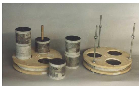
rys. 3. Symetryczny rdzeń amorficzny produkcji ATT
